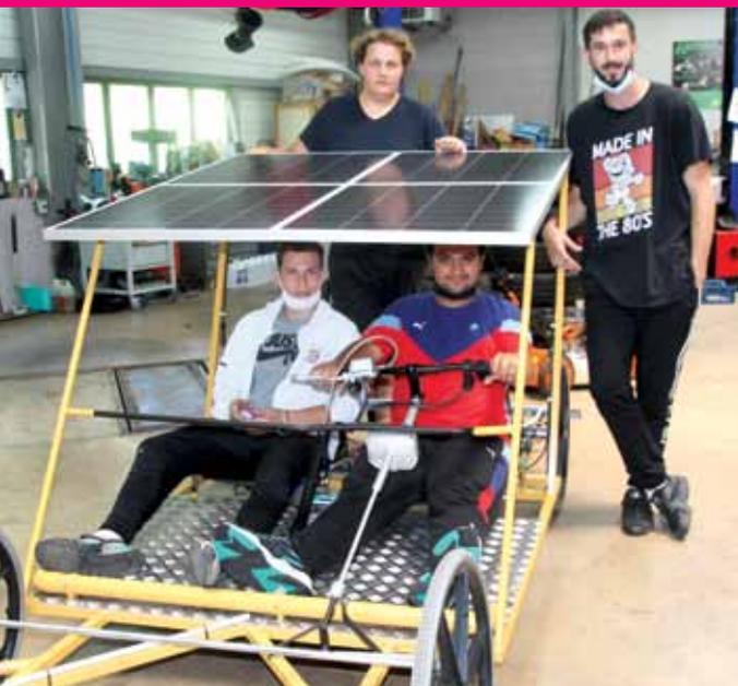
Réalisé à l'aide de matériaux de récupération (cadres, roues de fauteuils roulants, sièges d'occasion...) ce véhicule a été conçu de manière à optimiser son autonomie énergétique.
